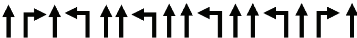
Слика 5: Пример линијског алгоритамског записа, помоћу кога се програмира образовни робот
